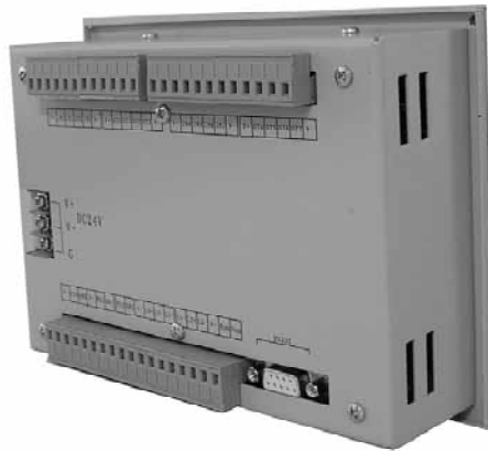
图 1-4 DMC300A 背部接线示意
